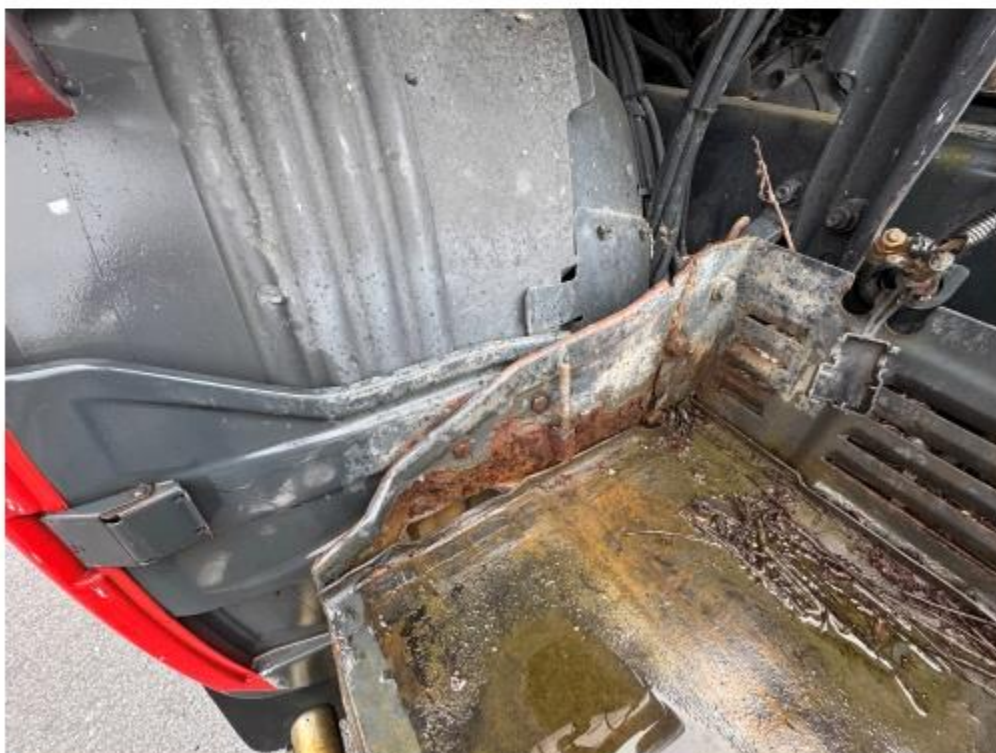
Korozika kutije akumulatora-koji nedostaju
