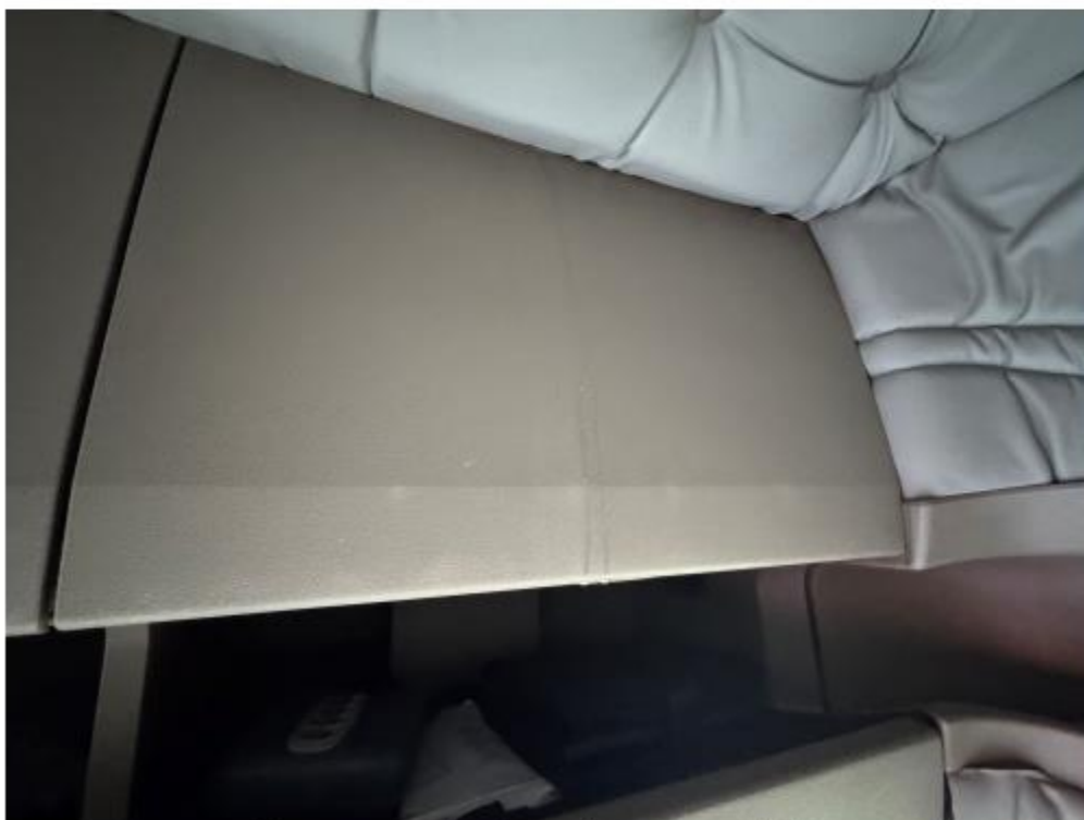
Mjesto propuštanja vode sa krova kabine
